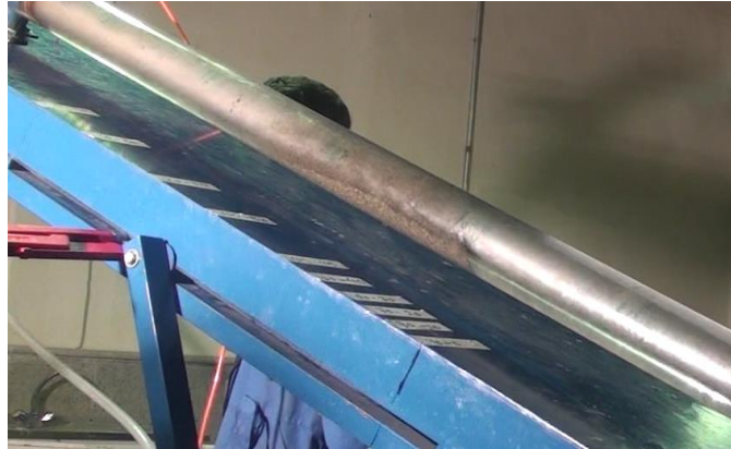
شکل ۴. شروع لغزش کنده‌ها به سمت انتهای فضای حلقوی در زاویه ۵۵ درجه و فاصله ۹۵ سانتی‌متری از انتهای سرمته
