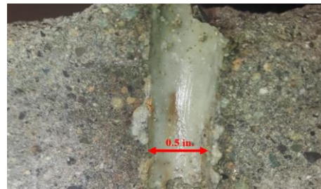
شکل ۹. کیک گل تشکیل شده بر دیواره چاه توسط سیال بنتونایتی (آزمایش شماره دو)
