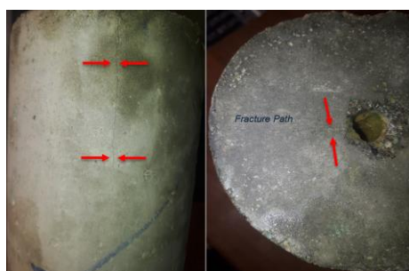
شکل ۸. شکاف عمودی ایجاد شده در نمونه در آزمایش
