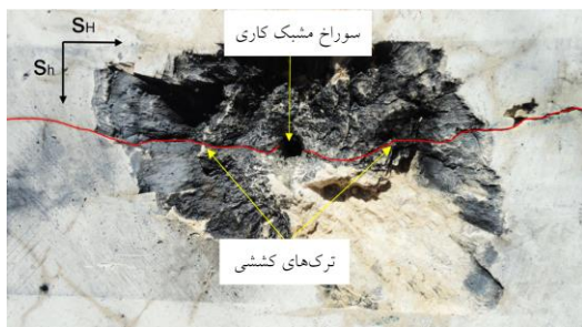
شکل ۷. انتشار دو ترک کششی در اطراف سوراخ
