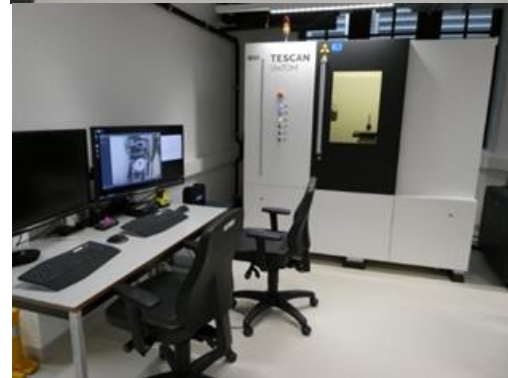
شکل ۱. دستگاه‌های تصویربرداری میکرو سی‌تی اسکن: تصویر بالا) Unitom XL تصویر پایین) Unitom HR
