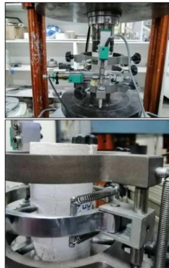
شکل ۴- وضعیت استقرار مغزه در دستگاه مقاومت فشاری تک‌محوری به انضمام چارچوب استقرار اهرم‌های انتقال تغییر شکل قطری ( LVDT^1 ).
