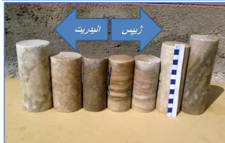
شکل ۲- دستگاه مغزه گیر و مغزه‌های تهیه‌شده جهت انجام آزمایش خزش، (ژیپس و انیدریت پورفیبری).
