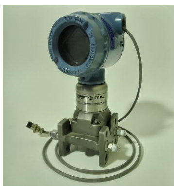
شکل ۲۲. دستگاه اندازه‌گیری اختلاف فشار [۱۲]
