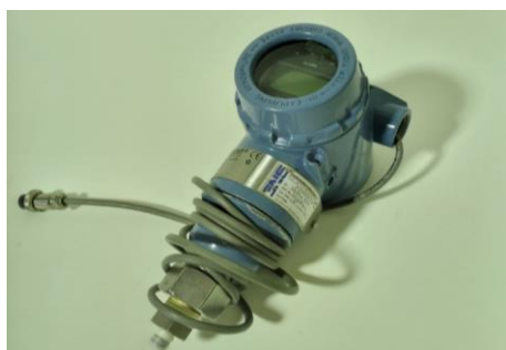
شکل ۲۱. دستگاه اندازه‌گیری فشار مطلق [۱۲]
