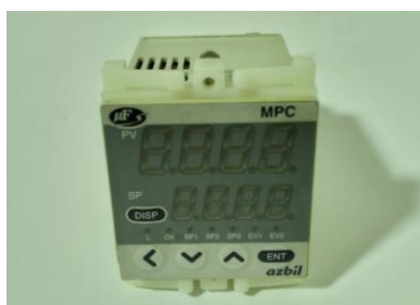
شکل ۲۴. دستگاه اندازه‌گیری نرخ جریان گاز نیتروژن [۱۲]
