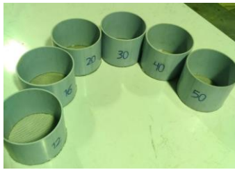
شکل ۶. سرند ساخته شده جهت دانه بندی ماسه‌ها [۱۲]
