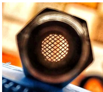
شکل ۲۳. مش فلزی جهت جلوگیری از حرکت دانه‌های پروپنت درون سلول هدایت‌پذیری [۱۲]
