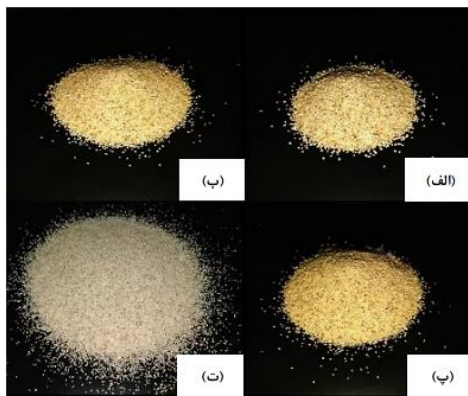
شکل ۷. نمونه ماسه‌های فیروزکوه با دسته سرند: (الف) ۱۶/۳۰، (ب) ۲۰/۴۰، (پ) ۳۰/۵۰ و نمونه ماسه همدان با دسته سرند (ت) ۲۰/۴۰
