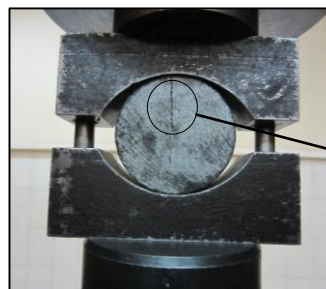
شکل ۸. نمونه‌ی شکسته شده‌ی آزمون برزیلی
