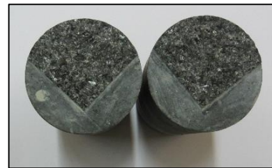
شکل ۶. نمونه‌های شکسته شده‌ی آزمون استوانه‌ای با شیار چورون
