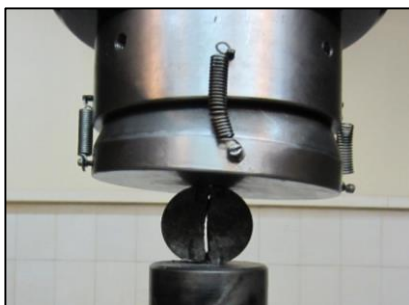
شکل ۱۰. نمونه‌ی شکسته شده‌ی آزمون برزیلی مسطح شده
