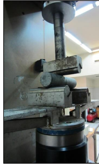
شکل ۵. شیوه‌ی انجام آزمون نمونه‌ی استوانه‌ای با شیار چورون
