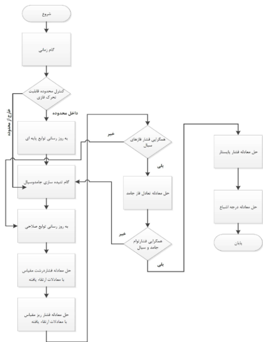
شکل ۳. الگوریتم مرحله به مرحله مدل چندمقیاسی ارتقاء یافته برای مدل‌سازی حرکت سیال در محیط متخلخل چندفازه با در نظر گرفتن اثرات موئینگی بین فازهای سیال
