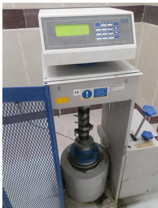
شکل ۵. متراکم سازی ملات ماده‌ی مدل در داخل قالب‌های استوانه‌ای فولادی به وسیله ماشین بارگذاری
