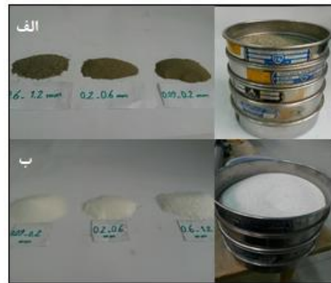
شکل ۱. دانه‌بندی به روش سرد خشک دو نوع ماده‌ی پرکننده. الف: ماسه و ب: سیلیس، بازه دانه‌بندی بین ۰٫۰۹ تا ۱٫۲ میلی‌متر هر یک در سه قسمت اندازه‌ی دانه‌ی ۰٫۰۹ تا ۰٫۲، ۰٫۲ تا ۰٫۶ و ۰٫۶ تا ۱٫۲ میلی‌متر
