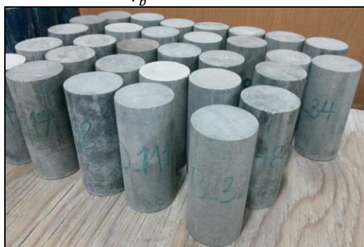
شکل ۶. برخی از نمونه‌های آماده‌سازی شده از مجموع ۱۹۲ نمونه دارای وزن حجمی و تخلخل مختلف با دو نوع مواد پرکننده‌ی ماسه و سیلیس
