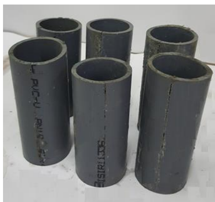
شکل ۲. قالب‌های استوانه‌ای آماده‌سازی شده از UPVC
