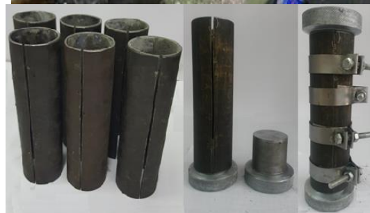
شکل ۳. قالب استوانه‌ای فولادی آماده‌سازی شده به قطر ۵۴ میلی‌متر و دو پیستون به قطر ۵۳/۴ میلی‌متر توسط دستگاه تراشکاری
