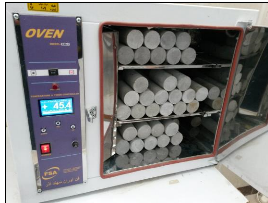
شکل ۷. نگهداری نمونه‌ها به مدت ۲ روز در دمای ۴۵ درجه در گرم‌خانه به منظور خشک شدن آن‌ها
