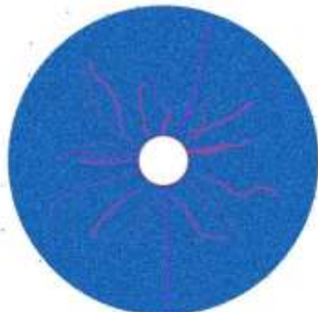
شکل ۶. مدل عددی شکست مقطع ۲ چاه مورد مطالعه در نرم افزار PFC2D
