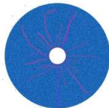
شکل ۵. مدل عددی شکست مقطع ۱ چاه مورد مطالعه در نرم‌افزار PFC2D
