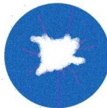
شکل ۹. مدل عددی تولید ماسه مقطع ۲ چاه مورد مطالعه در نرم افزار PFC2D
