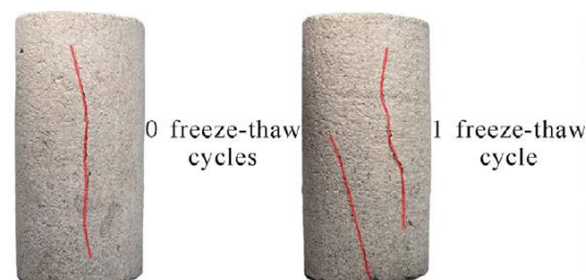
شکل ۷. تغییرات درزه‌ها در نمونه سنگ تحت تنش بعد از یک چرخه ذوب و انجماد [۲۰]
