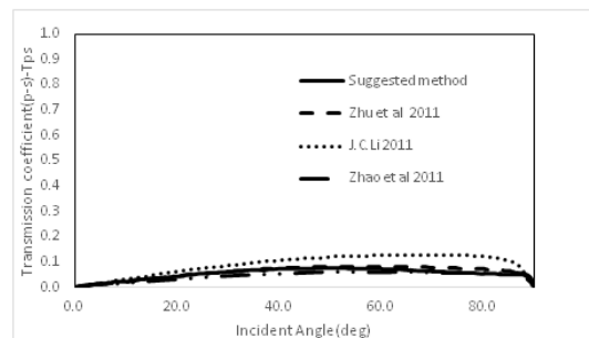
شکل ۸. تغییرات زاویه تابش موج ورودی بر T_{ps} برای حالت تک درزه
