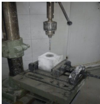
شکل ۲. سوراخ‌کاری نمونه‌های سیمانی
