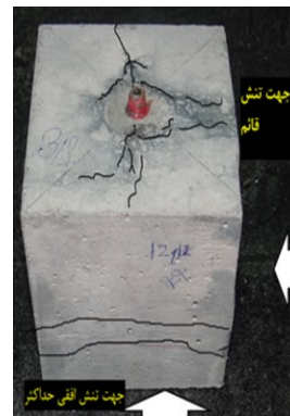
شکل ۱۰. بررسی تأثیر افزایش تنش افقی حداکثر در چاه افقی هم راستا با تنش افقی حداقل بر هندسه شکست (الف) نمونه شکسته شده (ب) نمودار فشار- زمان (آزمایش شماره ۸)
