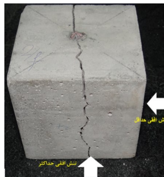
شکل ۸. بررسی تأثیر افزایش تنش افقی حداکثر در چاه قائم بر هندسه شکست (الف) نمونه شکسته شده (ب) نمودار فشار- زمان (آزمایش شماره ۶)
