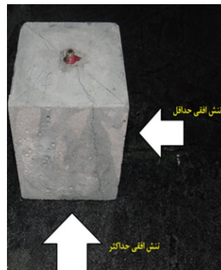
شکل ۷. بررسی تأثیر افزایش تنش قائم بر چاه قائم بر هندسه شکست (الف) نمونه شکسته شده (ب) نمودار فشار- زمان (آزمایش شماره ۷)
