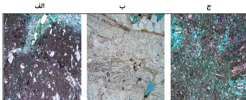
شکل ۴. مقاطع نازک تهیه شده از سازند سروک در مخزن کربناته واقع در جنوب غرب ایران. بخش‌های آبی نشان‌دهنده فضای خالی است. (الف) شکاف‌ها و شکستگی‌ها. (ب) حفرات بین‌دانه‌ای. (ج) حفرات انحلالی ماتریس.
