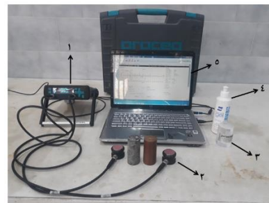
شکل ۴. اجزای تشکیل‌دهنده دستگاه PUNDIT Lab+ (۱) بدنه اصلی دستگاه (۲) مبدل (۳) میله کالیبراسیون (۴) ژل التراسونیک (۵) صفحه نمایش
