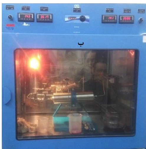
شکل ۷. الف) شمای کلی دستگاه اندازه‌گیری نفوذپذیری. ب) پمپ تزریق آب (۲) پمپ روغن به منظور اعمال فشار محصورکننده (۳) آون و محفظه نگهدارنده مغزه، ب) قسمت درون آون
