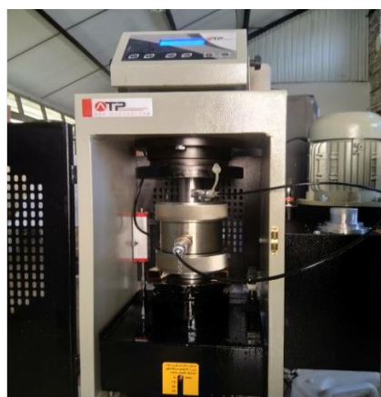
شکل ۴. سلول هوک قرار گرفته در دستگاه شکست تک‌محوره
