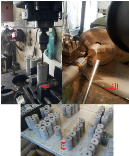
شکل ۳ (الف): مراحل سوراخ‌کاری نمونه با قطر ۱۳/۵ میلی‌متر، (ب): مرحله‌ی سوراخ‌کاری با قطر ۶ میلی‌متر و (ج): نمایی از چند نمونه‌ی سوراخ شده
