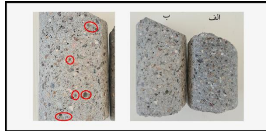
شکل ۷. عملکرد مته در حفاری نمونه‌ها بصورت الف) مماسی و برشی ب) تراشیدگی و ریز ریز کردن
