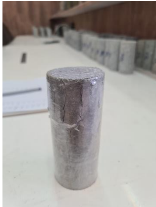
شکل ۱. نحوه شکست نمونه بعد از آزمایش تک محوره
