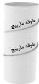
شکل ۴. هندسه بخش بدنه استوانه ریگ اسپار با طوقه مارپیچ
