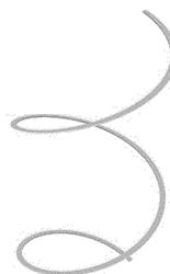
شکل ۷. هندسه بخش اسپیرال (طوقه مارپیچی) ریگ اسپار بدون سایر اجزای بدنه اسپار
