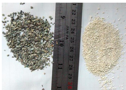
شکل ۴. نمونه‌ای از آهک و ماسه استفاده شده در تست‌های ۵ و ۱۵
