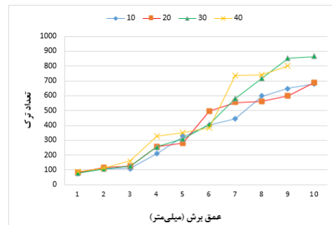
شکل ۲۰. رابطه بین عمق برش و تعداد ترک در سنگ آهک
